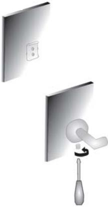
**WARNUNG:** Die Platte ist so zu installieren, dass sich der Griff der Platte mindestens 600 mm über dem Fußboden befindet.
